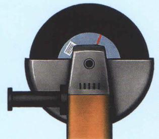
Запрещается работать без предохранительного кожуха
